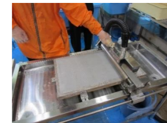
②パキューム係 (紙に含んだ水を吸い込む掃除機みたいなもの)
